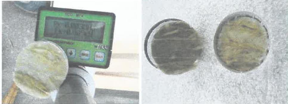
Рисунок 6 – Дослідний зразок № 90-2/21 при підготовці до випробування та типовий розрив
