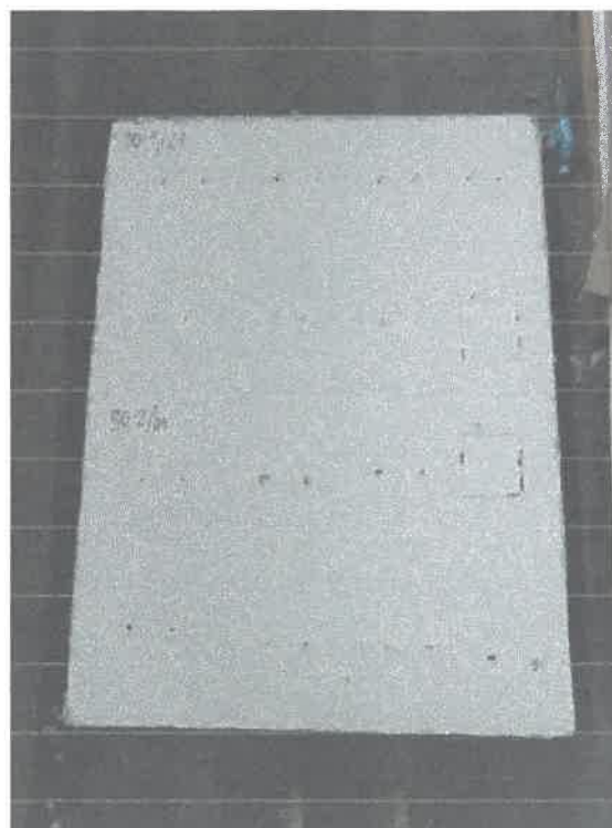
Рисунок 2 – Дослідний зразок № 90/21 до випробування визначення адгезійної міцності
