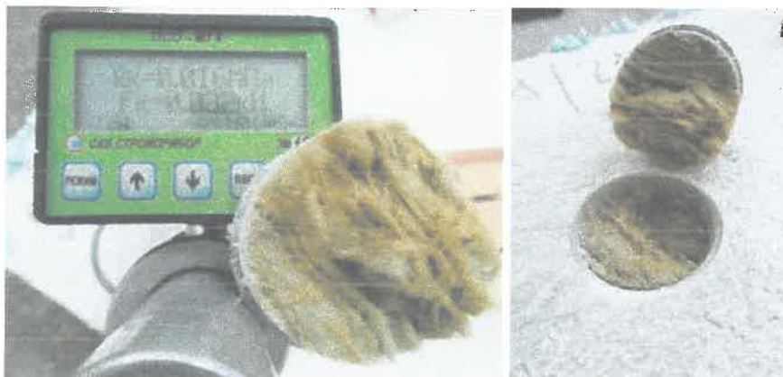
Рисунок 5 – Дослідний зразок № 90-1/21 при підготовці до випробування та типовий розрив
