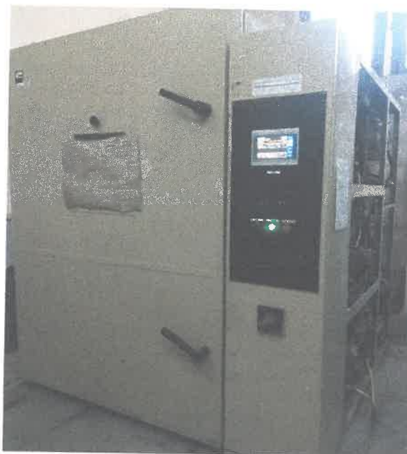
Рисунок 5 – Кліматична камера для проведення циклічних кліматичних впливів
